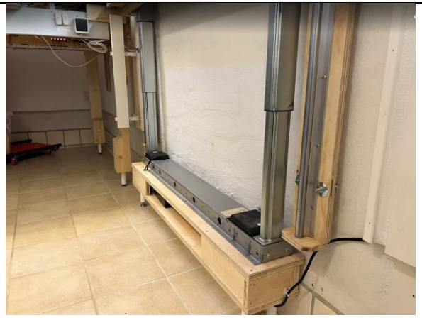
Styreboksen til hævesænke funktionaliteten får nu plads i 'fundaments kassen'
