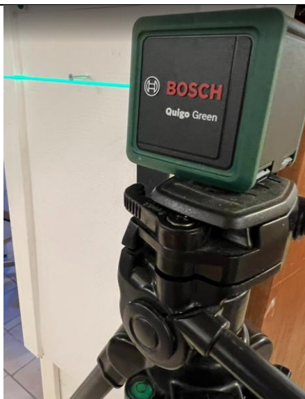
Jeg brugte en Bosch Quigo krydslaser til præcis indmåling
