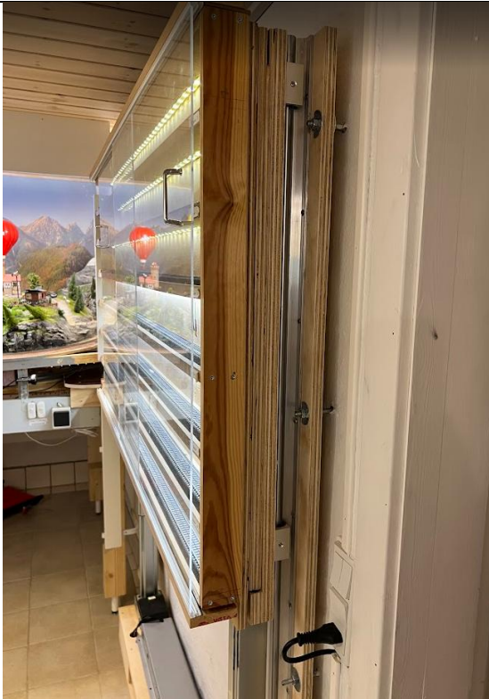
Klar til test – vitrinen er boltet fast til krydsfinerpladen med de 2 små 'vogne'
