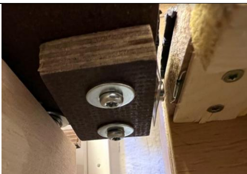
Reed-kontakt for hvert spor og magnet. Forbindes til S88 så positionen kan bestemmes.
