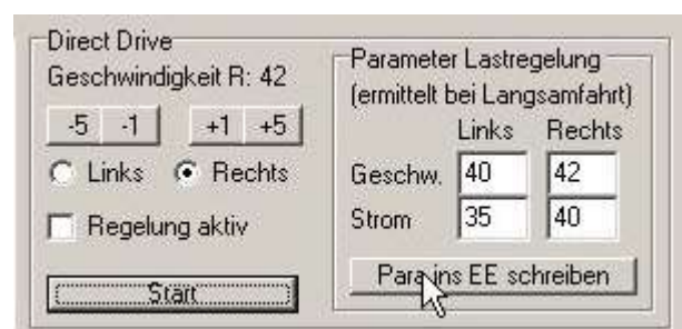
Abbildung 20: Direct Drive gestoppt, Button "Para ins EE schreiben" betätigen!
